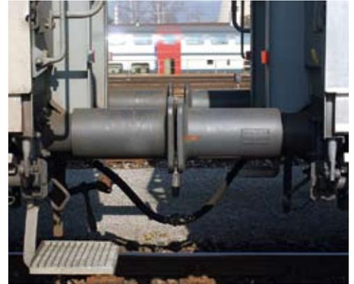
**44** Puffer bei einem Eisenbahnwagen. Sie dienen zum Abfedern mechanischer Stösse
